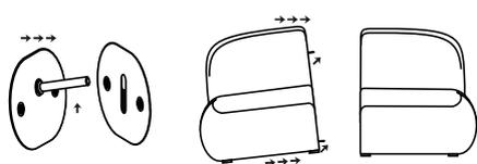
06- Aproxime o módulo e encaixe na posição conforme ilustração.
